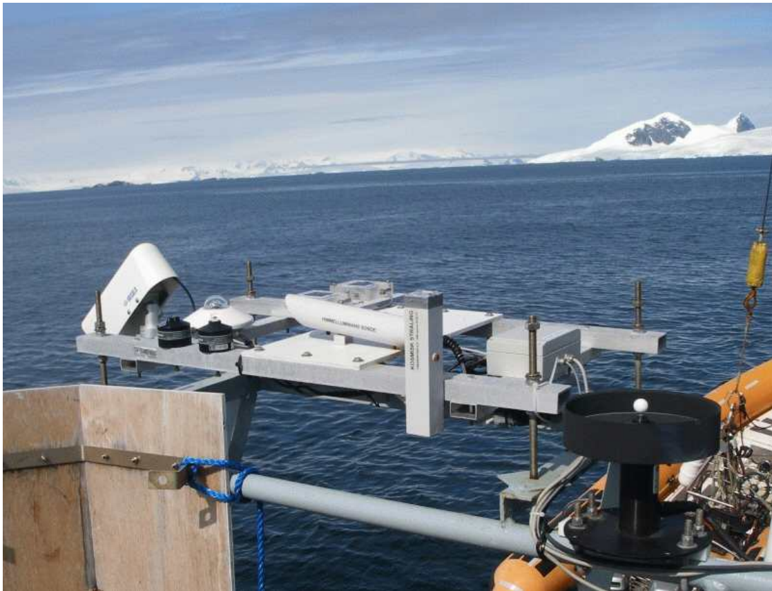
Figur 2: Optikbordet er en aluramme monteret på et stålboard, der er svejset fast ovenpå Vædderens Hydrografilaboratorium. Bordet ligger på skibets bagbordsside nær rælingen. Himmelluminanssonden peger direkte mod bagbord med en elevationsvinkel på 10 grader. (En stor tak til Tommy Nielsen og Lars Kolind for illustrationen. Palmerhalvøen, Antarktis, ses i baggrunden.)
